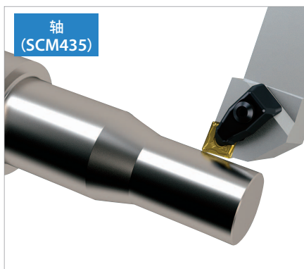
推荐切削速度 Vc : 200-300-400 (m/min)
