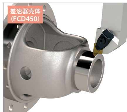
推荐切削速度 Vc : 150-250-300 (m/min)
