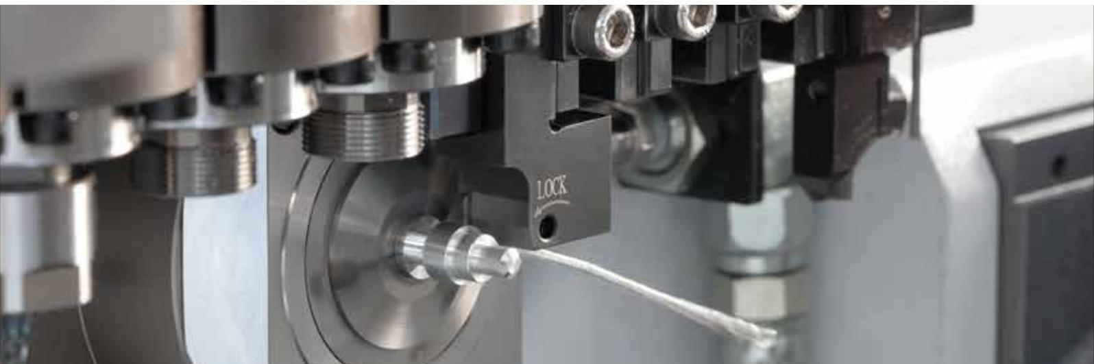
Y轴加工调整排屑方向, 抑制缠屑
